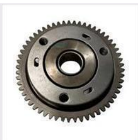
BENDIX11** BENDIX ARRANQUE COMPLETO HONDA STORM/ZANELLA RX150/SKUA C/CORONA
