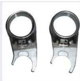
HORQUILLA1** JGO HORQUILLA SELECTORA CAMBIOS BIZ/ SMASH
