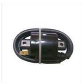
BOBINA51** BOBINA EXTERNA YAMAHA YBR 125 /FZ16
